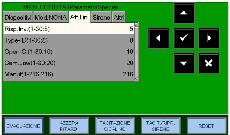
**Aumentando** i valori dei singoli parametri, la centrale diventa meno sensibile per le segnalazioni di guasto per i punti installati sulle linee.
