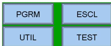
Questi tasti sono visualizzati nella parte inferiore dell'LCD. Attivano la funzione corrispondente. Le funzioni cambiano con i menù selezionati. Esempio: nel menù **stato impianto** questi tasti permettono l'accesso alle funzioni di: Programmazione, Utilità, Esclusione o a quella di Test.
