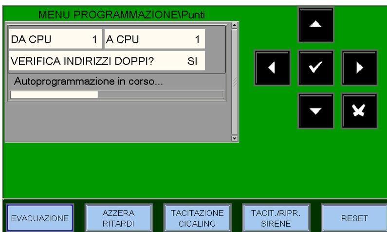
Al termine della procedura di auto-riconoscimento il display visualizza il riepilogo dei dispositivi rilevati sulla linea.
