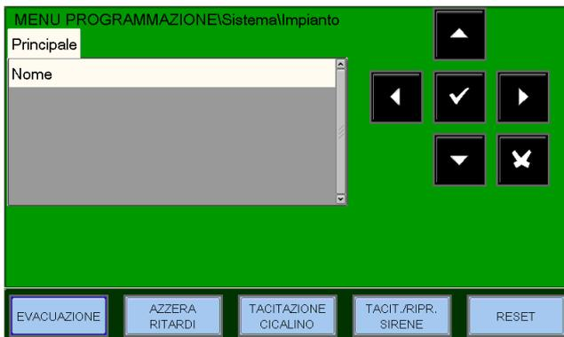
Per inserire il nome impianto premere il tasto invio e utilizzare la tastiera alfanumerica per inserire il testo.
