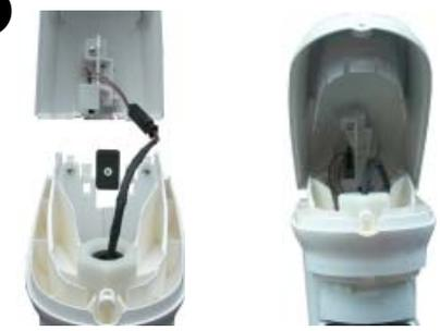
Collega il cavo del tamper alla basetta e chiudi il coperchio superiore verificando il funzionamento del contatto tamper
