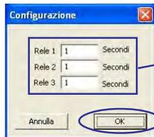
**O** - Si apre la finestra con cui è possibile configurare i tre relè attuatori, scegli per ognuno di essi il modo di funzionamento bistabile o temporizzato. Per il funzionamento bistabile programmare 0 sec. Per il funzionamento temporizzato programmare un tempo compreso tra 1 e 65535 sec. Compila i campi, tempo di commutazione dei relè
